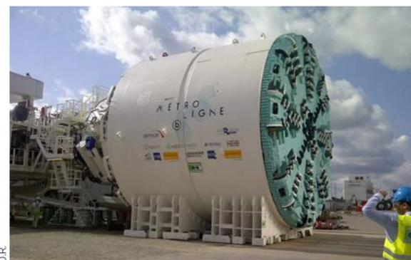
L'arrivée du tunnelier est prévue pour mi-2019. Fabriqué en Allemagne, il sera assemblé à l'intérieur de la station La Dhuis, à 15 mètres de profondeur. Il commencera ensuite le creusement de la galerie jusqu'à la station Serge-Gainsbourg (Les Lilas). Les 250 mètres restants seront creusés selon une méthode traditionnelle.
