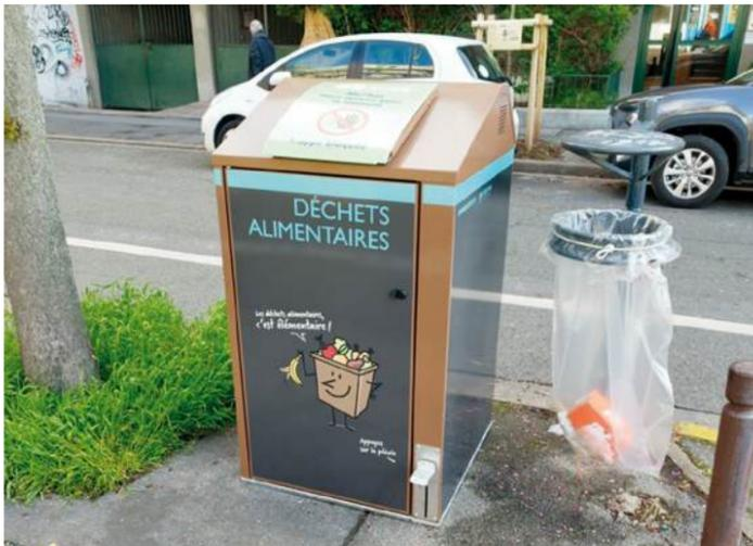
Les bornes sont équipées d'une pédale facilitant le dépôt de déchets.
