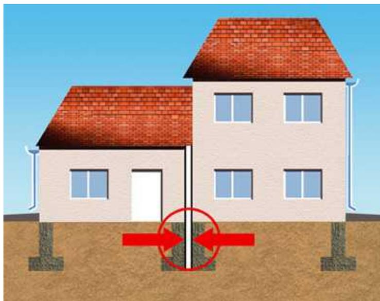
**Il est prescrit de désolidariser les parties de construction fondées différemment au moyen d'un joint de rupture sur toute la hauteur de la construction.**
